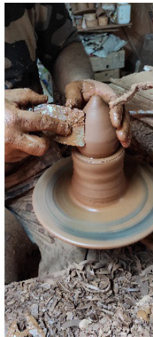
Figür 24: Düğme Dipli Şişenin Şekillendirme Aşaması.
