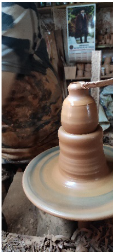
Figür 24: Düğme Dipli Şişenin Şekillendirme Aşaması.
